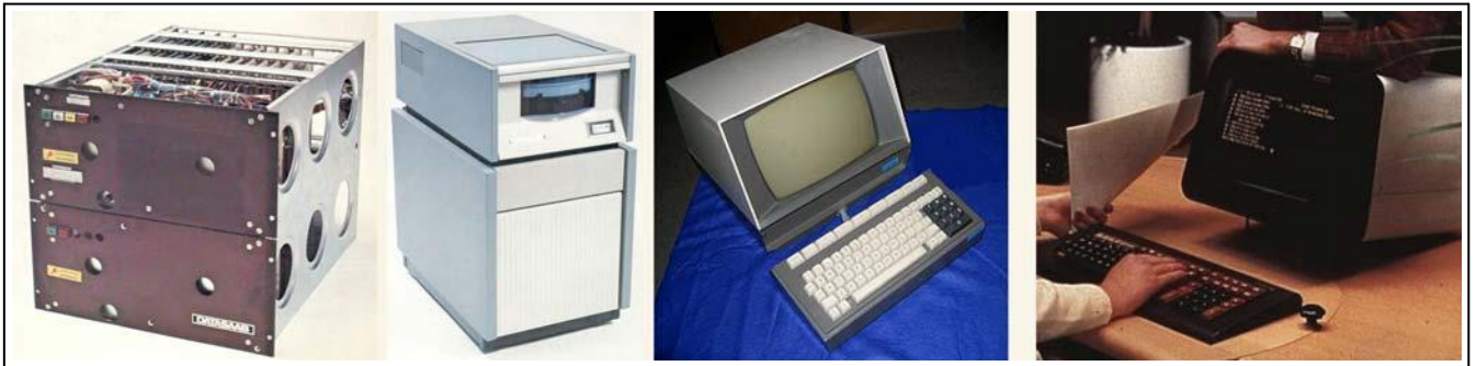
Innmaten i Saab-Scania's datamaskin D5/30 med tilhørende skiveaggregat og Alfaskop 3100 -skjerm fra Stansaab. Til høyre skjermen til deres datamaskin D16 som erstattet denne maskin omkring 1977.
